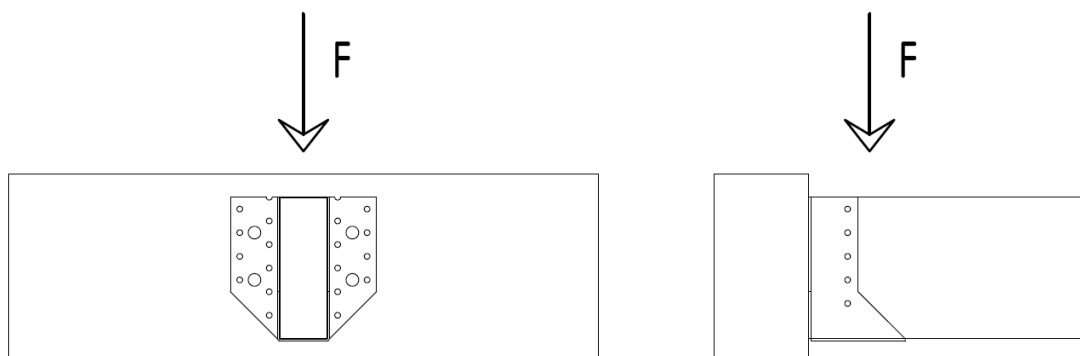
Obr. 1: Směr namáhání ve vztahu ke spojovaným prvkům – trimmer connection
