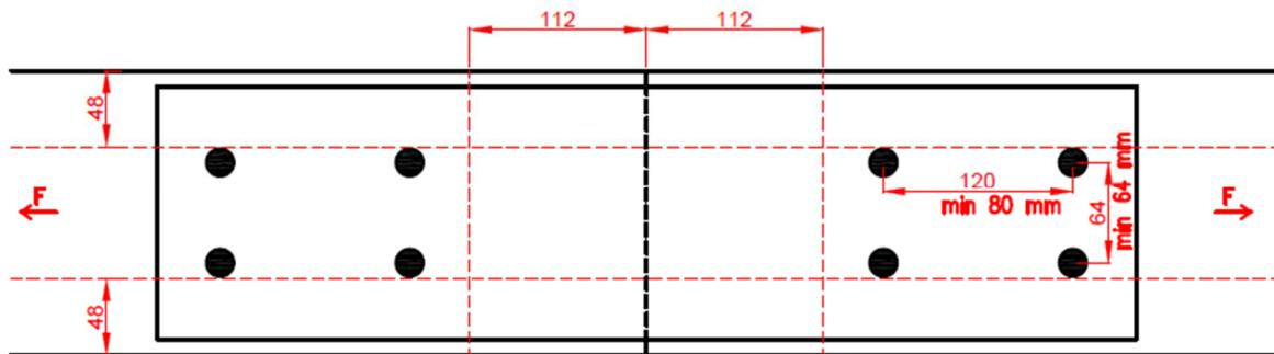
Obr. 1: Užití – podélný spoj
