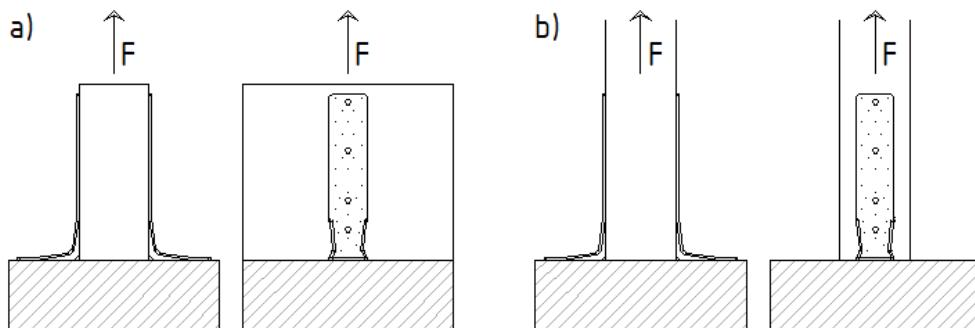
Obr. 1: Směr namáhání 1 ve vztahu ke spojovaným prvkům
